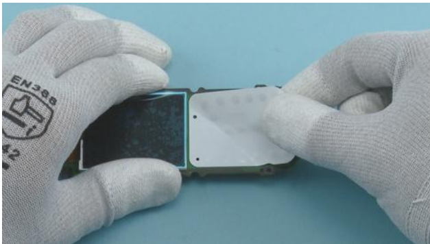
31) Peel of the DOMESHEET.
