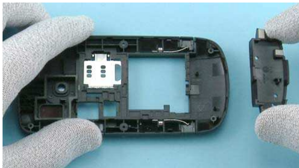
29) Remove the ANTENNA MODULE ASSY.
