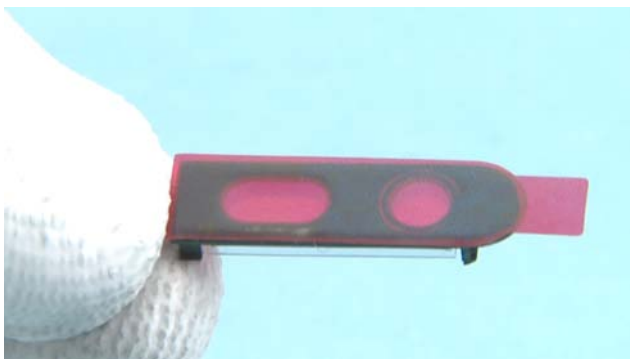
67) Remove the protective film from TOP END DECO.
