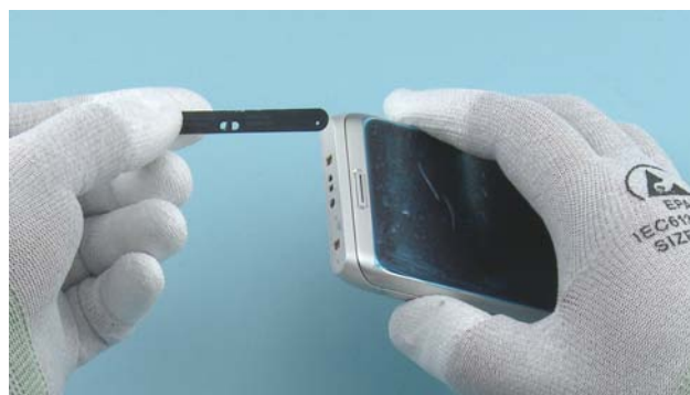
12) Remove the BOTTOM END DECO.
