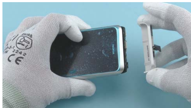
10) Remove the TOP END CAP.
