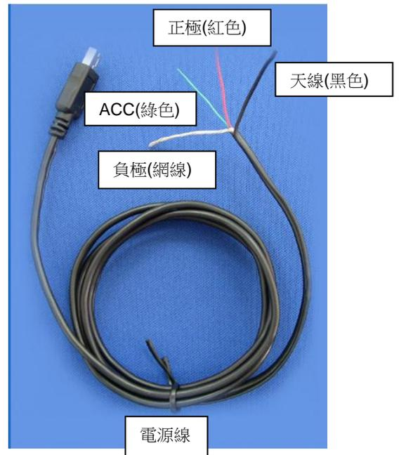
無線胎壓感測發射器安裝
