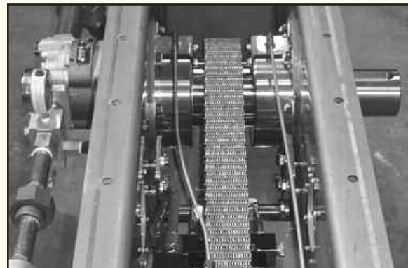
Transmission d'une soufflerie
