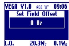
$$\text{TotalOffset[Hz]} = \text{FieldOffset[Hz]} + \text{LineOffset[Step]} * (\text{LineFrequency[Hz]} / 12)$$
