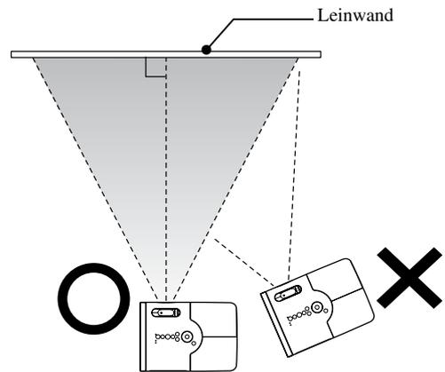
Wenn dieses Gerät sich nicht parallel zur Leinwand befindet, ist das projizierte Bild trapezförmig verzerrt.
