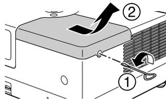
**3** Lösen Sie die Befestigungsschrauben der Lampe.
