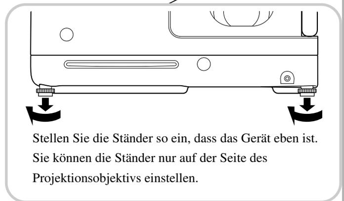
Wenn Sie den Fuß herausdrehen und das Gerät neigen, weist das Bild eine Trapezverzerrung auf. So gleichen Sie die Trapezverzerrung aus:
