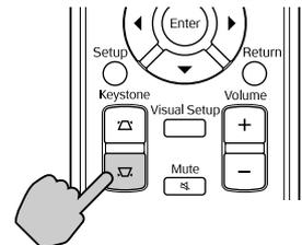
Wenn das Gerät um mehr als 15° Grad nach oben oder unten geneigt wird, kann die Bildform nicht mehr korrigiert werden. Es wird aber schwierig, das Bild scharf zu stellen, wenn der Neigungswinkel so groß ist.
