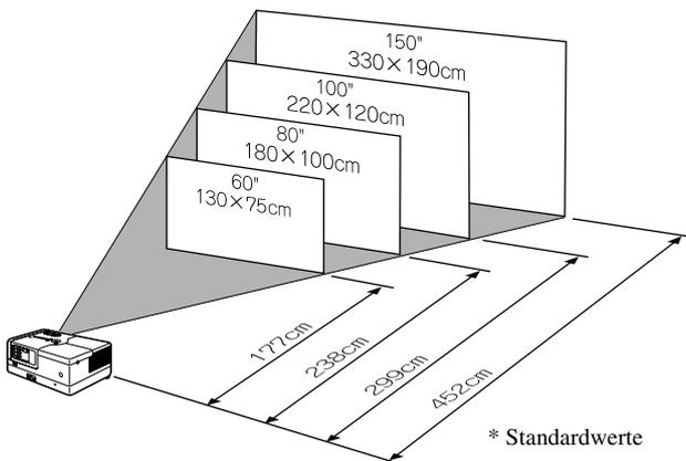
Je weiter das Gerät von der Leinwand entfernt wird, desto größer wird die Projektionsfläche.
