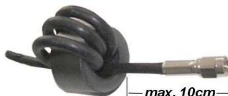
Abbildung 3 Antennenkabel mit EMV-Ringkernferrit
