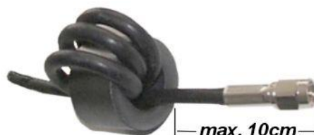
Abbildung 3 Antennenkabel mit EMV-Ringkernferrit
