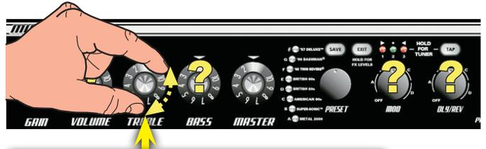
如果旋钮的位置和旋钮中保存的预置设定恰好有很大的区别,您可能在初次旋转可编程旋钮时听到音量或音色有巨大的变化。例如,如果音量旋钮指向“8”,但存储的音量预置设置是“2”,那在旋转音量旋钮使之激活时,音量水平将从“2”跳到“8”。
