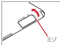
また、ドコモminiUIMカードやmicroSDカードの取り付け／取り外し後や外部接続端子使用後は次の図の示す方向にキャップを閉じ、ツメを押し込んでキャップの浮きがないことを確認してください。
