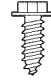
Vis à tête hexagonale n° 10 de 12,7 mm (1/2 po) de long pour boîte de jonction
