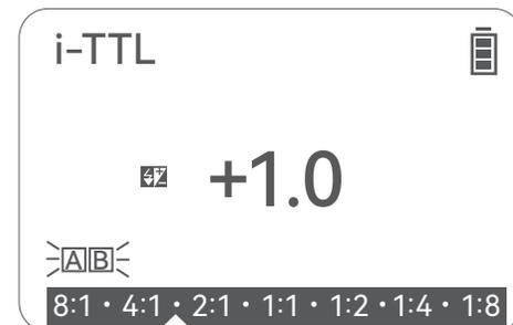
2. 短按SET按键可选<
