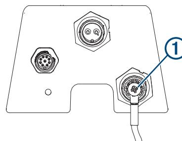
3 Täck jordningsskruven och krympkontakten med marint tätningsmedel.
