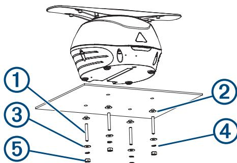
Per evitare danni al piedistallo, è necessario interrompere il serraggio delle aste filettate quando smettono di girare con facilità.
