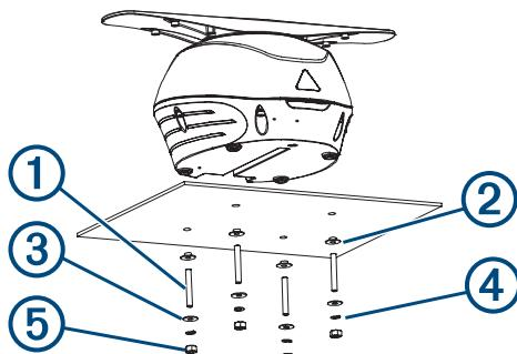
Damit der Standfuß nicht beschädigt wird, sollten Sie die Gewindestangen nicht weiter anziehen, wenn sie sich nicht mehr leicht drehen lassen.
