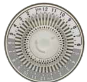
Figure 1 - Illustre le réglage de la minuterie pour mettre en marche l'appareil à 22 h (10 PM) et l'arrêter à 2 h (2 AM). Remarque que TOUS les segments entre 10 PM et 2 AM ont été réglés. L'heure actuelle est 20 h (8:00 PM).
