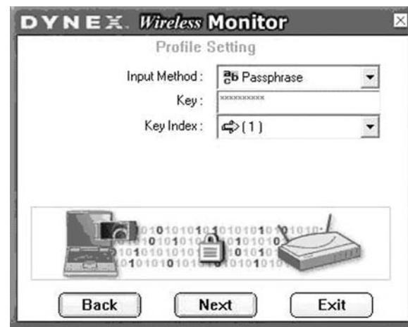
L'information cryptée reçue n'est acceptée que si elle se décrypte correctement. Cela ne se produit que si l'ordinateur a une clé WEP utilisée par le point d'accès. Cet écran permet la saisie de la clé WEP.
