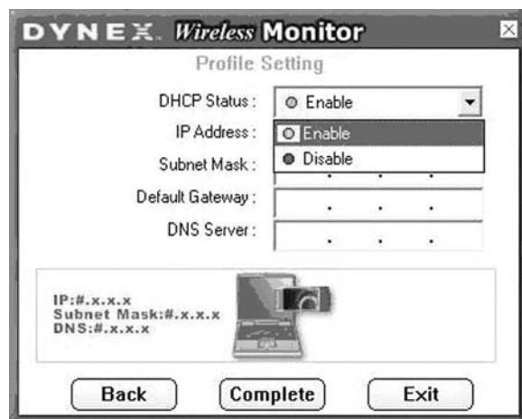
El propósito de esta pantalla es configurar los ajustes de TCP/IP de cada conexión inalámbrica. Debe definir si la configuración IP del perfil actual está asignada por un servidor DHCP o por una dirección IP fija que el administrador de la red determina.
