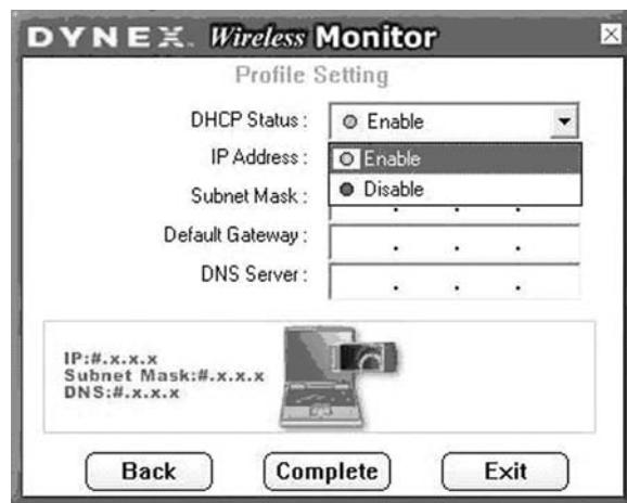
L'objet de cet écran est de configurer les paramètres TCP/IP pour chaque connexion sans fil. Il est nécessaire de définir si le paramétrage IP du profil actuel est affecté par un serveur ou par une IP statique, ce qui est déterminé par l'administrateur du réseau.
