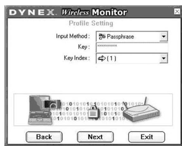
Cuando se recibe información codificada, sólo se aceptará si se decodifica correctamente. Esto sucede sólo si la computadora tiene la clave WEP usada por el punto de acceso. Esta pantalla le permite ingresar la clave WEP.
