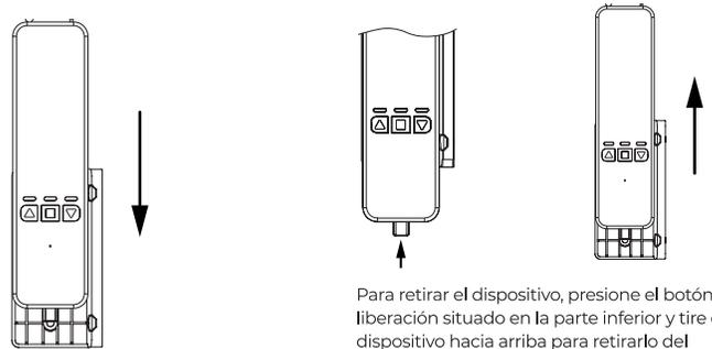
Para retirar el dispositivo, presione el botón de liberación situado en la parte inferior y tire del dispositivo hacia arriba para retirarlo del soporte de montaje.
