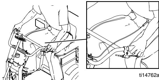
3. Disengage Rear Wheel Brake (G).
