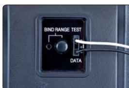
Branchez le cordon adaptateur, selon la vue, dans la fiche DATA située au dos de l'émetteur. Ce système de prise est équipé de détrompeurs, attention aux petites arêtes latérales. Ne forcez pas, la prise doit pouvoir se brancher sans effort.
