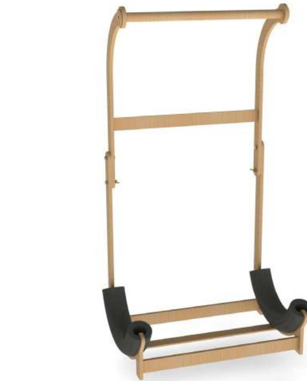
Mit diesem Rahmen kann der Modellbauer leicht und ohne sich zu bücken, sein Schiffsmodell am Ufer ins Wasser setzen. Der Rahmen wird aus ausgelasertem Buchensperrholz zusammenmontiert. Um ihn leichter transportieren zu können, kann der Rahmen nach Lösen von zwei Schrauben zusammengeklappt werden. Das Modell liegt auf PU Schaumrohren geschützt auf.
