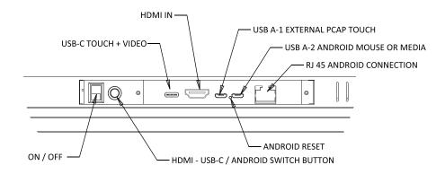
NOTE: HDMI - USB-C / ANDROID SWITCH BUTTON (GRREN) TOGGLES BETWEEN USING ANDROID AND USB-C OR HDMI INPUT
