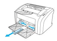
**3** 放置信封時,使要列印的一面向上,並且使信封的上邊緣靠著紙材導板的左側。最多可堆疊 15 個信封。
