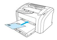
3 依據信封的長度和寬度調整紙材導板。
