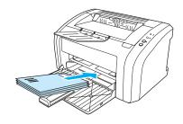
如果信封在較短的一端上有封口,則該端應先進入印表機。
