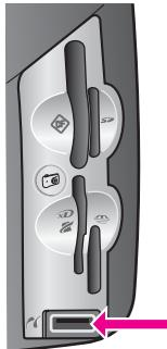
Ako umetnete HP bt300 u uređaj HP all-in-one i na grafičkom zaslonu u boji se pojavi poruka **No Bluetooth** (Bluetooth nije pronađen), isključite adapter iz uređaja HP all-in-one i pogledajte **Ažuriranje uređaja**.
