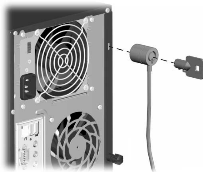
Kensington-vaijerilukon asentaminen Compaq Evo D300 -sarjan Microtower-malliin
