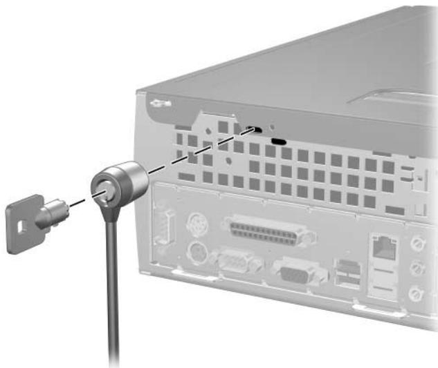
*Instalar uma fechadura de cabo*
