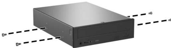
*Instalar parafusos-guia na unidade de leitura óptica*
