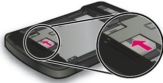
**NOTA:** se la batteria è già installata, rimuoverla prima di inserire la scheda SIM. La scheda SIM è acquistabile da un fornitore di servizi di telefonia mobile. Accertarsi che i contatti metallici siano rivolti verso il basso e che l'angolo ritagliato si trovi nella posizione corretta. Se la scheda SIM non
