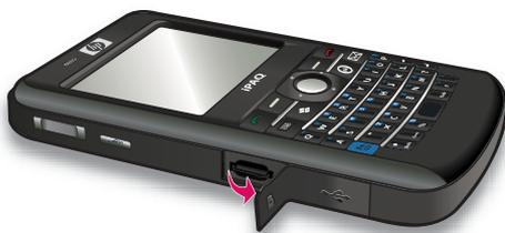
2. Inserire la scheda di memoria nello slot MicroSD con l'area metallica in avanti e rivolta verso la parte posteriore dell'HP iPAQ.
