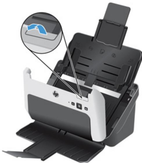
3. En la parte posterior del alimentador de documentos abierto, deslice la punta del dedo sobre la ficha de la esquina superior derecha de la cubierta del rodillo alimentador, sujétela firmemente y tire hacia adelante para abrir la cubierta del rodillo alimentador y exponer los rodillos alimentadores superiores.
