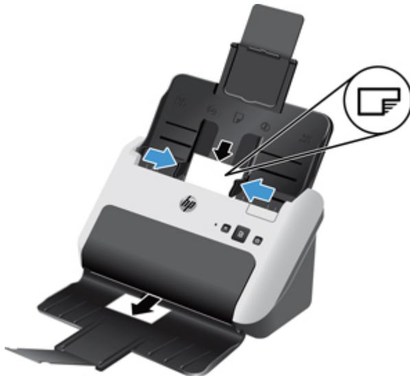
2. Ajuste las guías del papel para centrar las tarjetas y asegúrese de que las guías estén en contacto con los bordes de las tarjetas.
