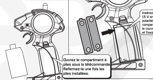
Insérez 2 piles AA de 1,5 V en respectant la polarité indiquée dans le compartiment. Replacez le couvercle du compartiment et fixez-le à l'aide de la vis.
