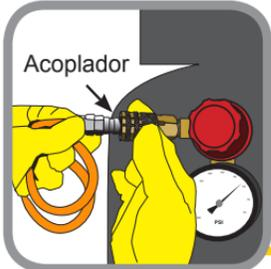
**1** Conecte la línea de aire al acoplador.
