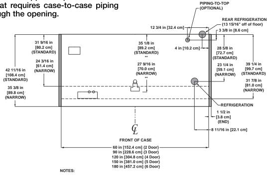
\*\* RECOMMENDED STUB-UP CENTERLINE FOR ELECTRICAL AND HUB DRAINS
