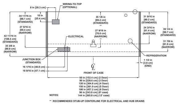
• WIRING-TO-THE-TOP- ADDS APPROXIMATELY 1 INCH TO CASE HEIGHT
