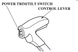
DUAL TYPE POWER TRIM/TILT SWITCH (LEFT) (RIGHT) CONTRÒL LEVERS
