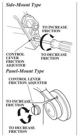
TO INCREASE FRICTION CONTROL LEVER FRICTION ADJUSTER
