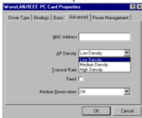
Figure 4-2 Access Point Density Parameter
