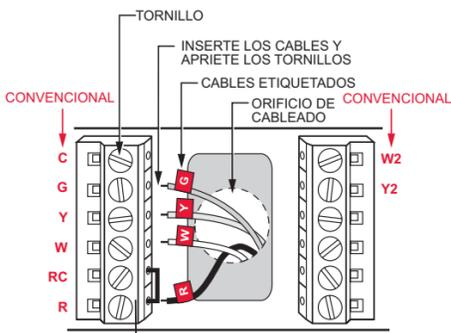
Retire el empalme metálico si tiene los cables "R" y "Rc".
