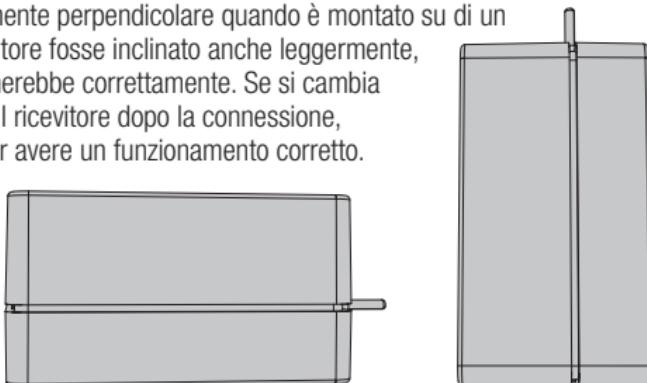
Installare il ricevitore sul veicolo usando il nastro in spugna biadesiva fornito, in questo modo, oltre a tenere fermo il ricevitore, lo si protegge anche dalle vibrazioni.
