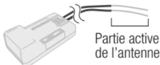
**REMARQUE :** Ne pas couper, tordre ou modifier les antennes. Toute détérioration de la partie coaxiale d'une antenne en réduira les performances. Le raccourcissement ou le sectionnement de l'embout de 31 mm réduira la portée.
