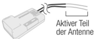
**HINWEIS:** Die Antennen nicht schneiden, knicken oder modifizieren. Schäden am koaxialen Bereich der Antenne wird die Leistung der Antenne reduzieren. Ein Kürzen oder Abschneiden der Spitze von 31 mm wird den Bereich reduzieren.
