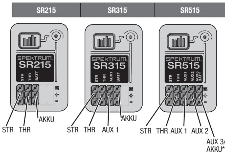
**\*WICHTIG:** AUX 3 auf SR515 teilt sich den Servo-Anschluss mit dem Akku. Am AUX-3-Anschluss ist ein Y-Kabel (SPMA3008) erforderlich, um alle 5 Kanäle mit einem Empfänger-Akku zu verwenden.
