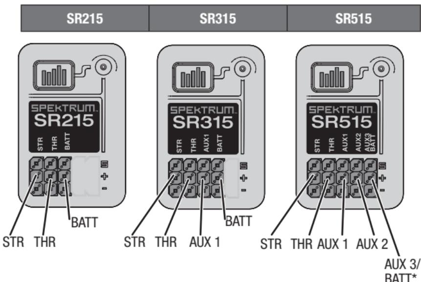
**\*IMPORTANT :** AUX 3 sur le SR515 partage le port de servo avec la batterie. Un harnais en Y (SPMA3008) est nécessaire sur le port AUX 3 pour utiliser tous les 5 canaux avec une batterie de récepteur.
