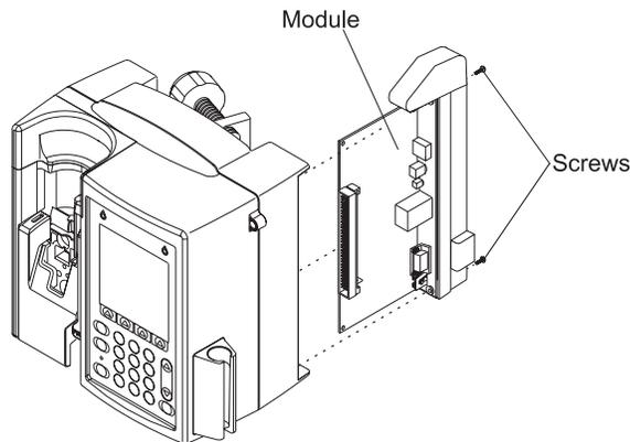
**Figure 2. Insert Module**
