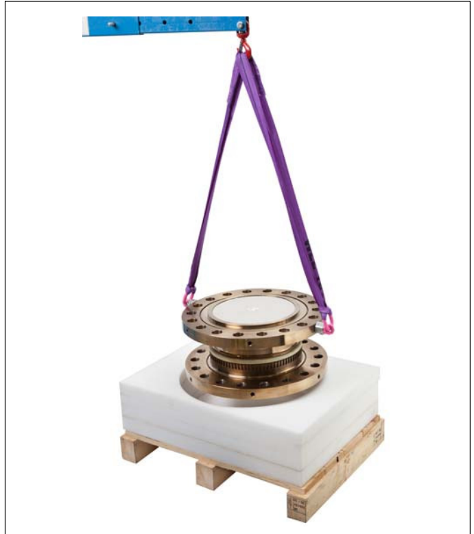
Abb. 5.2 Rotor aus der Verpackung heben
