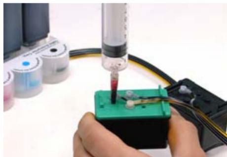
3. 稍待片刻等壓力平衡後，取出針管，以氣孔塞將氣孔塞緊
