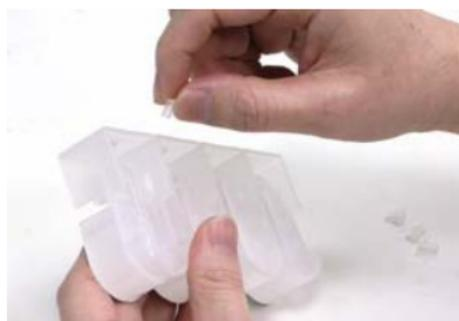
將接頭套管裝入底部進墨孔。
