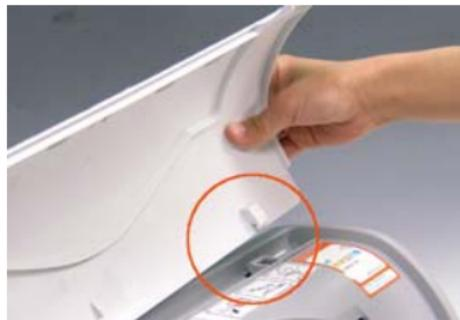
請在拔去電源的狀態下，將印表機上蓋卸下，先觀察卡榫狀態，握住兩邊、單邊往上用力拔起。
