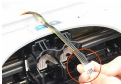
管線須從印表機背後繞過，在置入墨匣前，先在管線裝上小固定夾。
