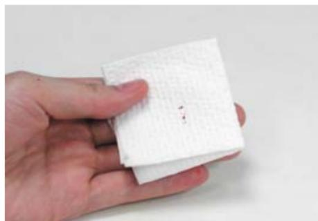
你可以看到沾印痕跡，檢視噴嘴沾印痕跡。如上圖顯示出墨不良…
