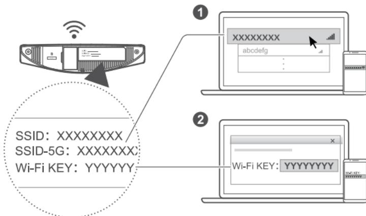
Gdy router nawiąże połączenie z komórkową siecią transmisji danych, można przyłączyć komputer lub telefon komórkowy do sieci Wi-Fi routera, by uzyskać dostęp do Internetu. Etykieta na spodzie routera zawiera domyślną nazwę sieci bezprzewodowej (**SSID**) i hasło (**Wi-Fi KEY**).
