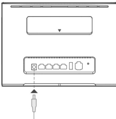
Włóż kartę micro-SIM do gniazda na kartę micro-SIM zgodnie z ilustracją powyżej. Następnie podłącz router B525 do zasilacza. Router zostanie automatycznie włączony i rozpoczęcie wyszukiwanie sygnału sieci komórkowych.
