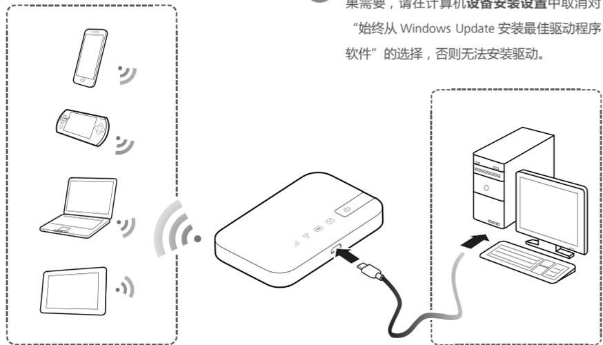
计算机可以通过 USB 线连接 E5 接入因特网。计算机首次通过 USB 连接 E5 时，您需要根据提示信息安装驱动。
