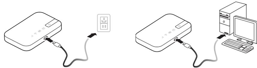
**i** 请使用原装充电器（额定输出：DC 5V，1A；匹配充电器型号：HW-050100C2W）进行充电。如果使用不匹配的充电器，可能影响 E5 的性能，甚至导致危险，同时违反 E5 保修条款和国家关于通信终端产品的相关规定。
