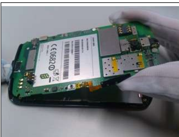
12. Remove the PCBA.
