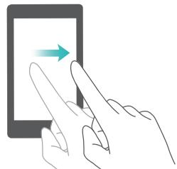
**Deslizar:** Deslice los dedos por la pantalla. Deslice el dedo vertical u horizontalmente para buscar otras pantallas principales, deslizarse por documentos, etc.
