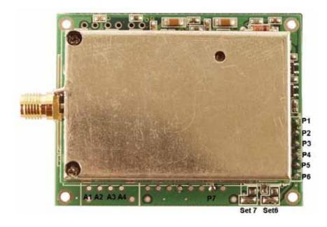
PIN A1,A2,A3,A4=FREQUENCY SETTING,(PIN A1 IS LSB,PIN A4 IS MSB)
