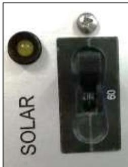
Fig. 110 – SOLAR switch on the GREEN module
