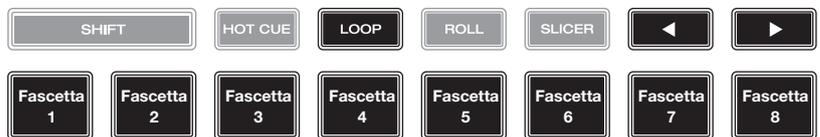
In modalità Manual Loop è possibile utilizzare ciascun pad per attivare un loop assegnato. Premendo Loop per la prima volta si entra sempre in modalità di Loop manuale.
