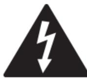
DANGEROUS VOLTAGE: The lightning flash VOLTAJE PELIGROSO: El triángulo con un rayo alerta de la existencia de un “voltaje peligroso” no aislado en el interior del producto, lo bastante elevado como para constituir un riesgo de descarga eléctrica en las personas.
