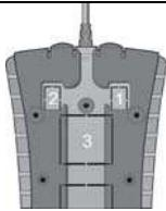
**Remarque:** Prévoir une longueur de câble suffisante dans le socle afin de pouvoir retirer le terminal du socle et atteindre les connecteurs
