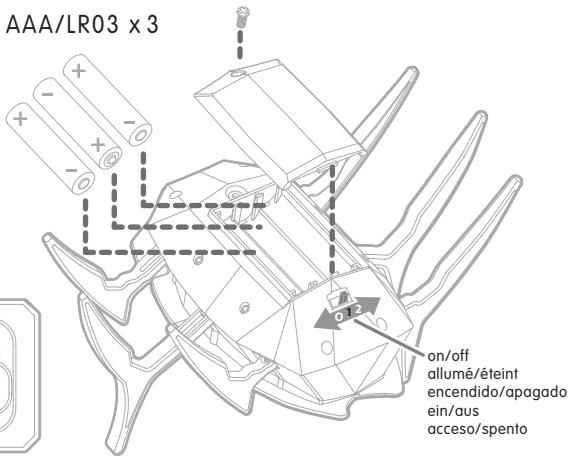
Open door to install & remove battery./Ouvrir le compartiment pour installer et retirer les piles./Abrir el compartimento para instalar y retirar las pilas./Öffnen Sie das Fach, um die Batterien einzulegen und wechseln zu können./Aprire lo sportello per installare e rimuovere la batteria.
