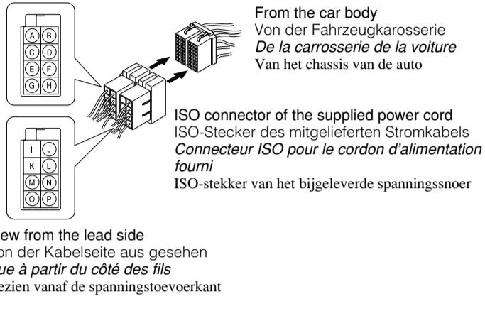
**For some VW/Audi or Opel (Vauxhall) automobile / Bei bestimmten VW-/Audi- oder Opel-(Vauxhall)-Fahrzeugen / Pour certaine voiture VW/Audi ou Opel (Vauxhall) / Voor bepaalde VW/Audi en Opel (Vauxhall) auto's**
